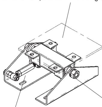
Mecanismo de ajuste para el pre-tensado de la Unidad Elástica ROSTA
