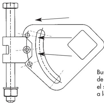
Busca la inclinación ideal de tu placa base (2) mediante el sistema de ajuste (7) fijándolo a la placa de fricción (6).
