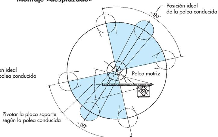
Si la polea conducida está por encima ó por debajo de la polea motriz, entonces colocaremos el motor «descentrado» sobre la placa. Encontraremos la inclinación ideal a través del sistema de ajuste (7) fijado por la placa de fricción (6).
