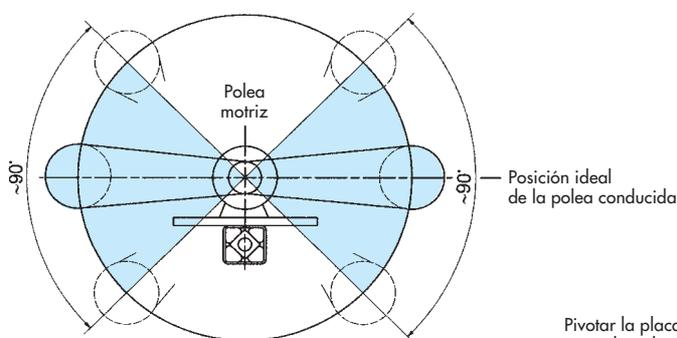
Si la polea conducida está lateralmente colocada respecto a la polea motriz ( $\pm 45^\circ$  arriba ó debajo de la línea central), colocaremos el motor «centrado» sobre la placa.
