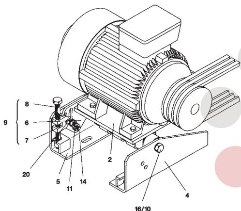
3. Gira el Tornillo de gato M20 (8) en sentido horario para levantar el motor y colocar las correas en la polea.
