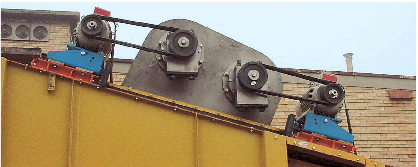
MB 50 en una criba para asfalto
